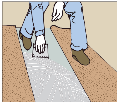
●くせの強い床材の施工に
