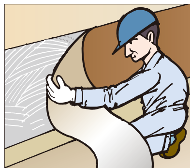
●塩ビタイル・シートの腰壁への施工
