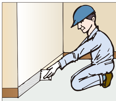
●ソフト巾木・ワイド巾木の施工
